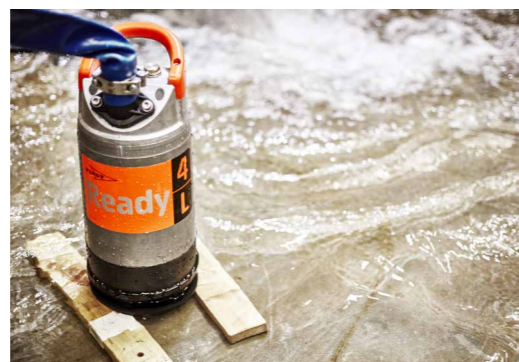
Wypompowuje wodę do poziomu 1-2 mm. Stojąc na płaskiej powierzchni: Hmax: 10,5 m oraz Qmax: 3,2 l/s.
